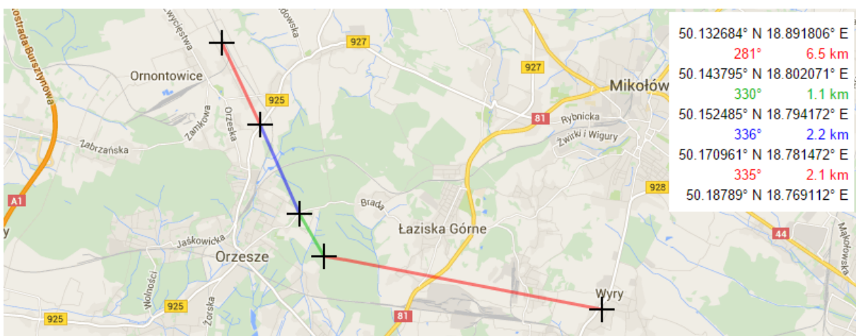
Rysunek 42. Strefy Fresnela zaznaczone na profilu topograficznym przy częstotliwości 24 GHz, krzyżki na mapie oznaczają umiejscowienie masztów.
